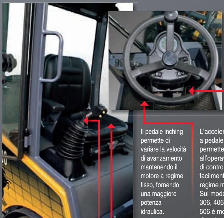
Il joystick multifunzione comanda il braccio di sollevamento, la benna e la funzione flottante, oltre al senso di marcia e alle funzioni idrauliche ausiliarie. Sui modelli 306, 406 e 506 comanda la 2ª velocità e il bloccaggio del differenziale.
