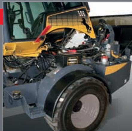
**ACCESSO PER MANUTENZIONE** ▲ facilitato da un grande cofano motore che fornisce l'accesso al motore, al liquido di raffreddamento e all'olio idraulico. Il tetto di protezione ribaltabile lateralmente, assistito da molle a gas, si solleva facilitando l'accesso per la manutenzione dell'impianto idraulico e della batteria.
