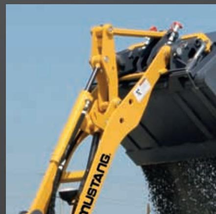
**UN PROGETTO INTELLIGENTE** ▲ garantisce che le tubazioni idrauliche e le articolazioni del caricatore scompaiano intelligentemente nel braccio di sollevamento quando viene sollevato al massimo, proteggendo le linee idrauliche durante il sollevamento o lo scarico.
