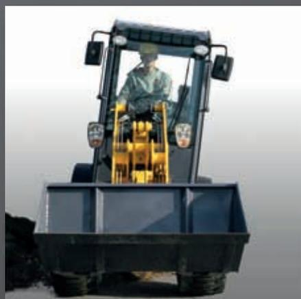
**ADERENZA AL TERRENO** ▲ con un telaio oscillante di 10 gradi in entrambe le direzioni che mantiene la trazione della macchina. Anche su terreno accidentato, l'oscillazione mantiene i pneumatici a contatto con il terreno.
