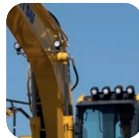
Fari di lavoro a LED (di serie in combinazione con la lama)
