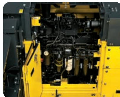
Disposizione centralizzata dei filtri
