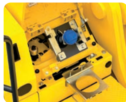
Il serbatoio AdBlue® è posizionato sulla scala anteriore. Il piano di lavoro compreso facilita ulteriormente il rabbocco di AdBlue®.
