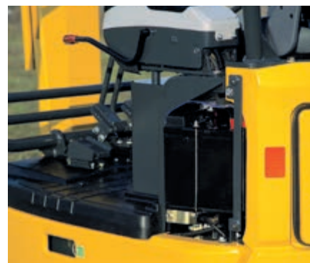
Cofano sinistro: accesso alla batteria
